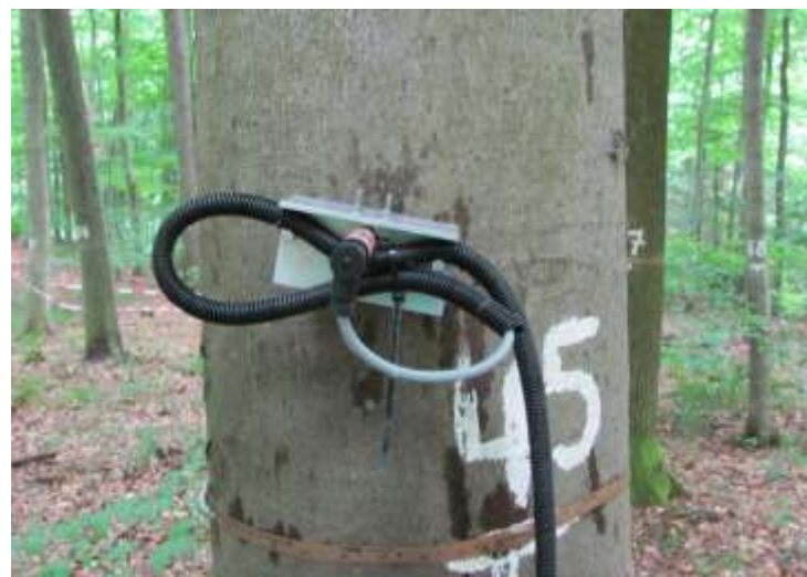
Abb. 45: Zuwachsmessung mittels eines Dendrometers; hier an einer Buche (Foto: A. Hölscher)
