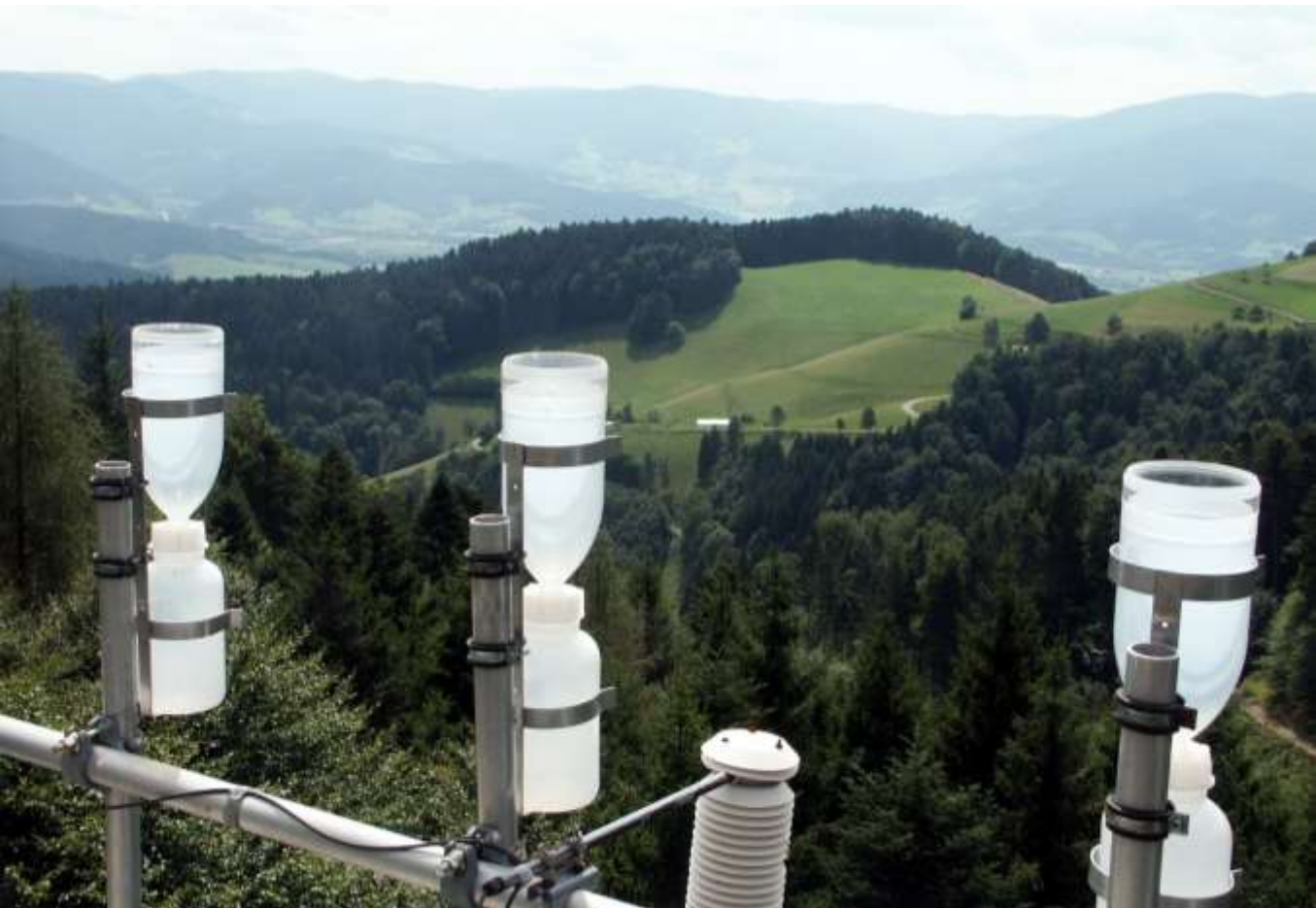
Abb. 61: Auffangbehälter zur Messung der Freilanddeposition; Messturm Conventwald (Foto: A. Hölscher)
